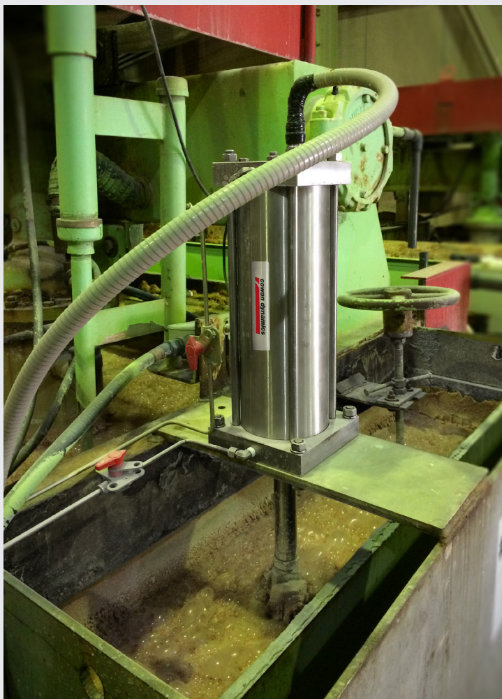
Serie AT de acero inoxidable de 8" de diámetro con posicionador remoto en una planta de potasa
