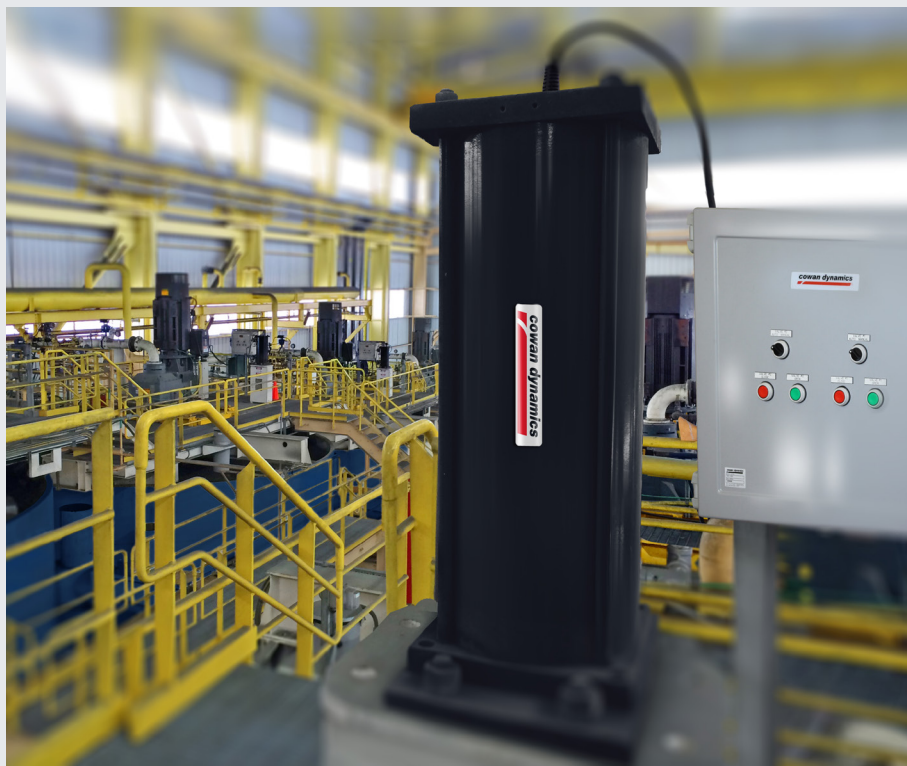
Serie AT de 14" con panel de control neumático, que opera una válvula de dardo para una aplicación de celda de flotación minera
