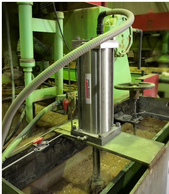
Serie AT de acero inoxidable con posicionador remoto en una planta de potasa
