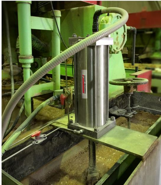
Modèle AT en acier inoxydable avec positionneur à distance dans une usine de potasse
